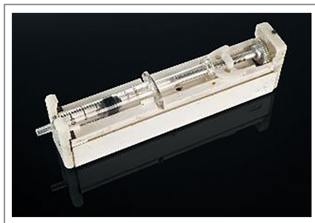
Рис. 5. Портативная инсулиновая помпа Mill Hill Infuser, разработанная Гарри Кином и Джоном Пикапом (1977–78 гг.) [18].
