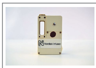
Рис. 11. Инсулиновая помпа с микропроцессорным управлением Nordisk Infuser (1983 г.) [25].
