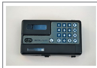
Рис. 12. Одна из первых помп с индивидуально программируемым базальным профилем CPI/Eli Lilly 9100 (1982 г.) [25].
