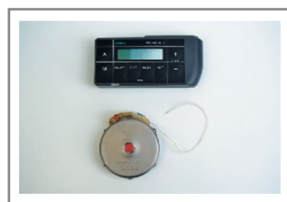
Рис. 10. Имплантируемая (вживляемая под кожу) помпа Promedos, усовершенствованная версия (1992 г.) [25].
